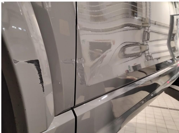
1.1 Skade venstre fordør og forskjerm
