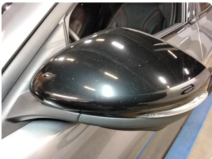
2.5 Øvrige feil /Steinsprut
