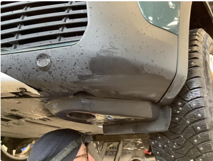
1.3 Små skrubbskader underkant
