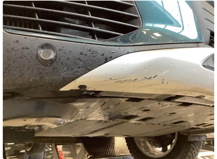
1.3 Små skrubbskader underkant
