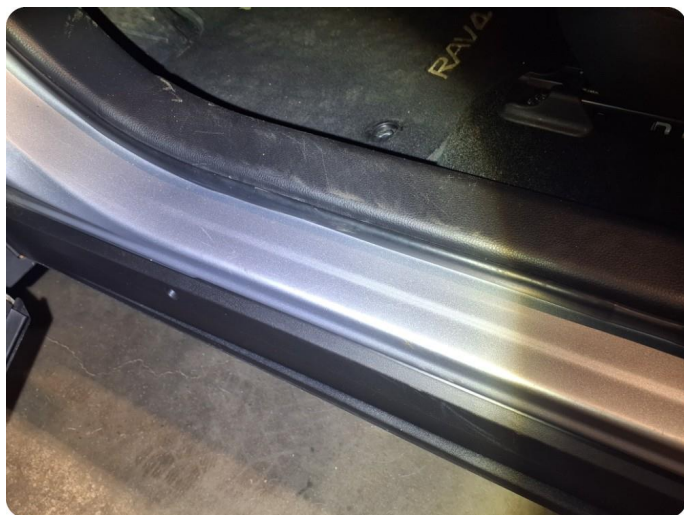
2.1 Generelt mye riper og småbulker Og steinsprut
