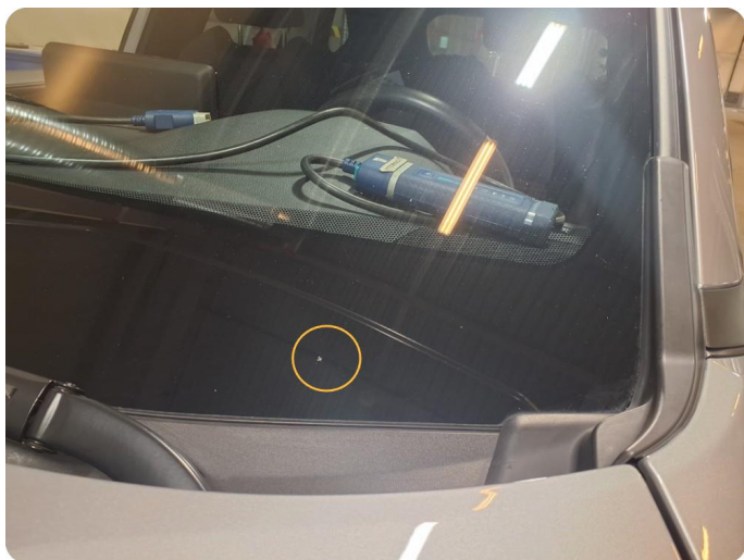
2.6 Steinsprut med sprekk
