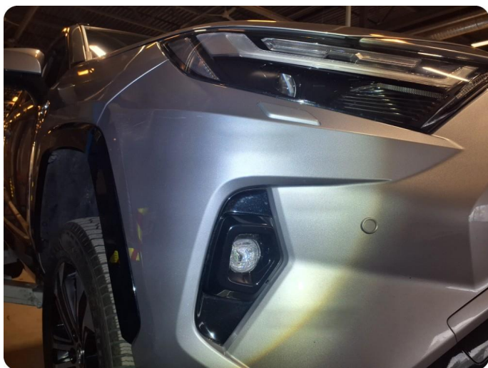
2.1 Generelt mye riper og småbulker Og steinsprut
