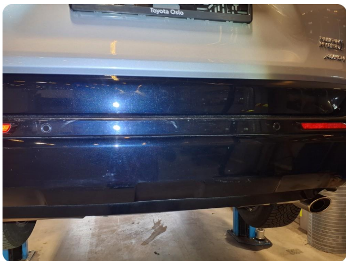
2.1 Generelt mye riper og småbulker Og steinsprut
