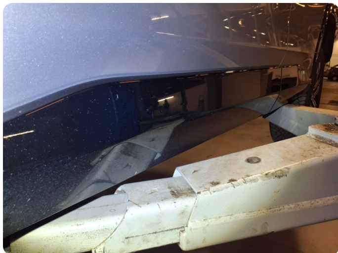
2.1 Generelt mye riper og småbulker Og steinsprut
