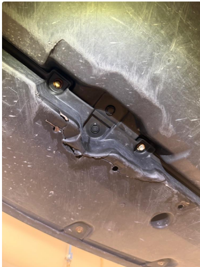
1.1 Beskyttelsesplate noe skadet
