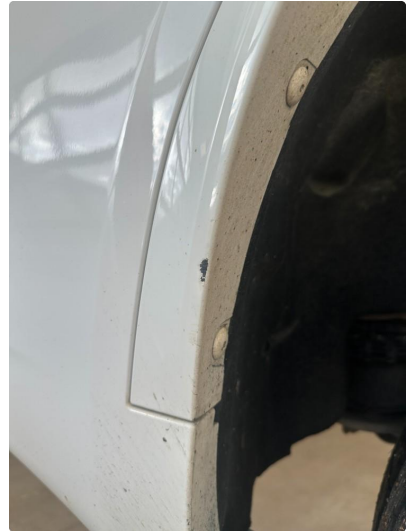
1.1 Noen små sår i skjermutbygger høyre bak
