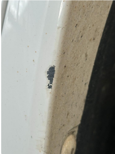
1.1 Noen små sår i skjermutbygger høyre bak
