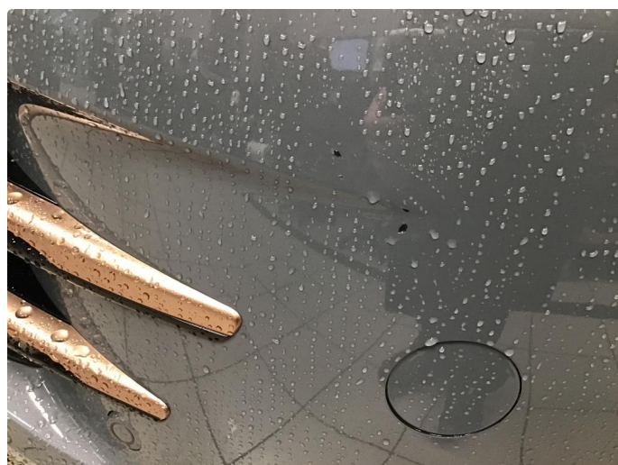
1.3 Noen steinsprut på frontfanger
