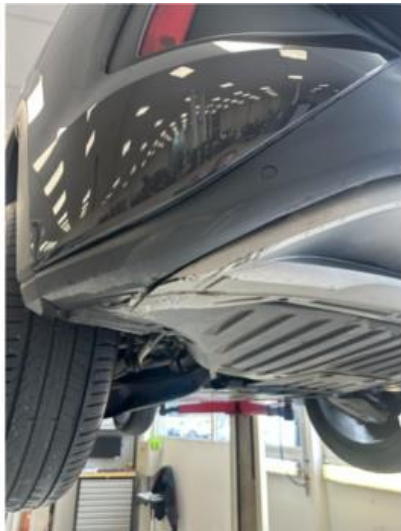
1.1 Litt oppripet underside fanger foran
