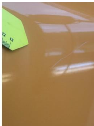
1.2 Svak bulk og lita ripe i dør høyre bak
