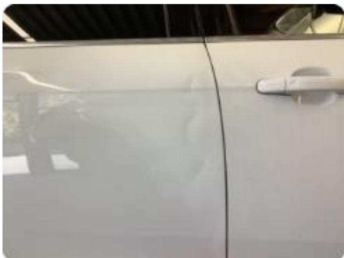
1.1 Noe lakkslitasje og noen bulker
