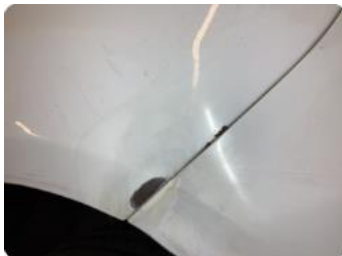
1.1 Noe lakkslitasje og noen bulker
