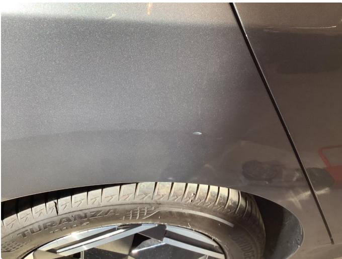
1.1 Noen riper og småbulker
