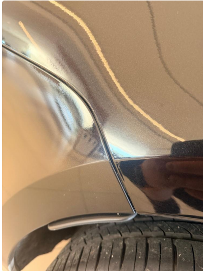
1.1 Påbegynnelse av rust mellom bakfanger og baksjerm høyre side
