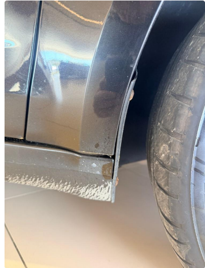
1.2 Slitasje fremkant høyre kanal
