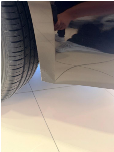
1.3 Slitasje etter vannsprut bunn bakfanger bak bakhjul
