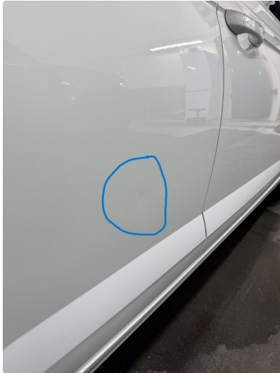
1.1 Liten parkeringsbult høyre bakdør. (ikke gjennom lakk)
