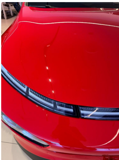
1.1 Steinsprut i panser
