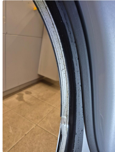
1.1 Steinsprut med rust
