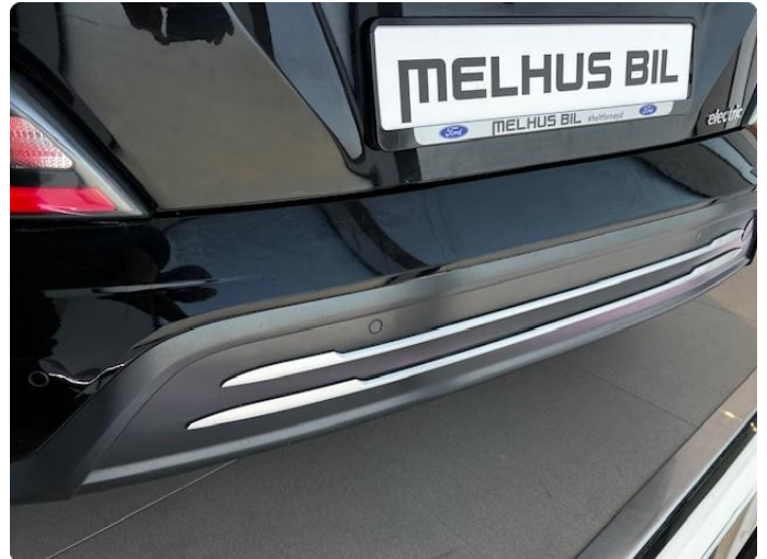
1.4 Riper støtfanger bak.
