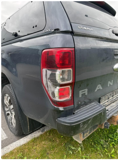
2.1 Fukt i baklykt venstre.
