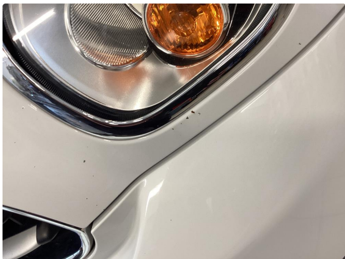
1.3 Noe steinsprut med rust
