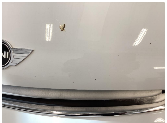
1.3 Noe steinsprut med rust
