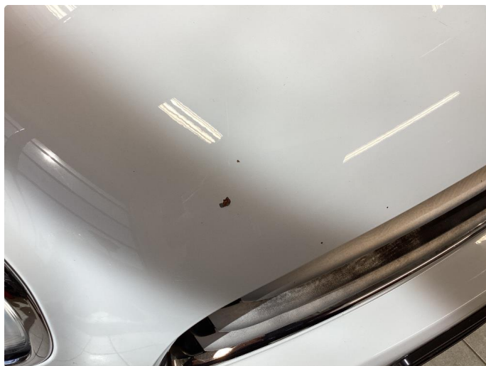
1.3 Noe steinsprut med rust
