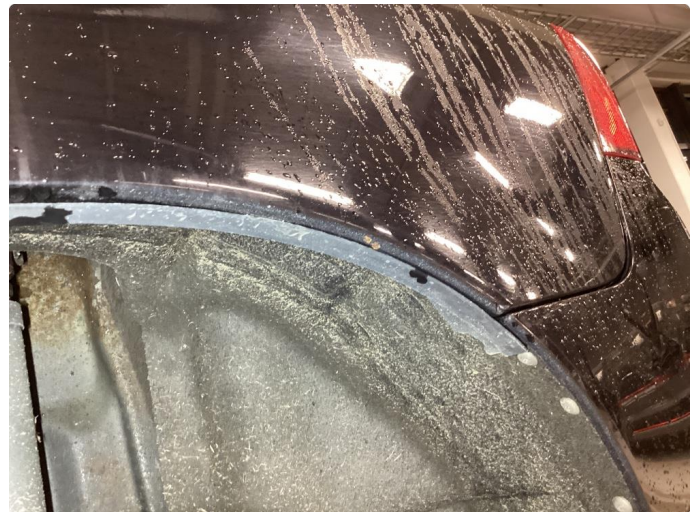
1.3 Steinsprut med rust
