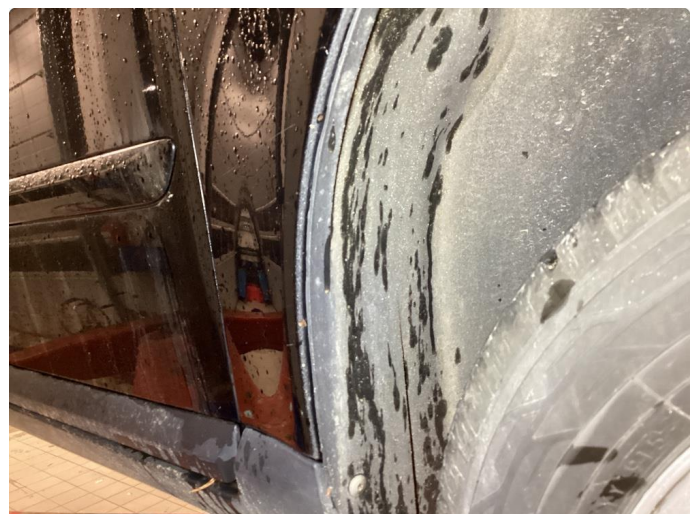
1.3 Steinsprut med rust
