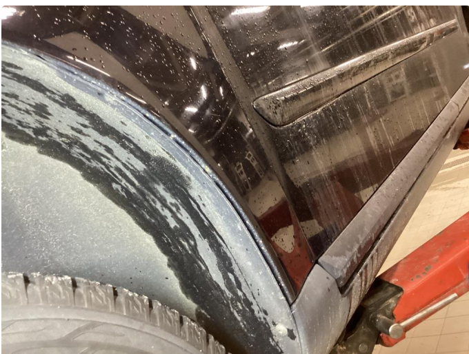
1.3 Steinsprut med rust
