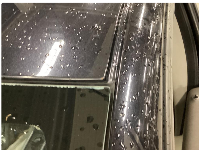
1.11 Steinsprut med rust
