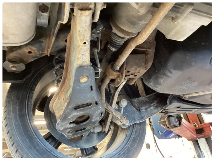
1.1 Ikke alvorlig rust
