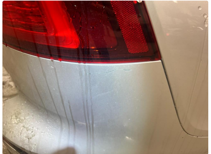
1.3 Ripe i støtfanger høyre bak
