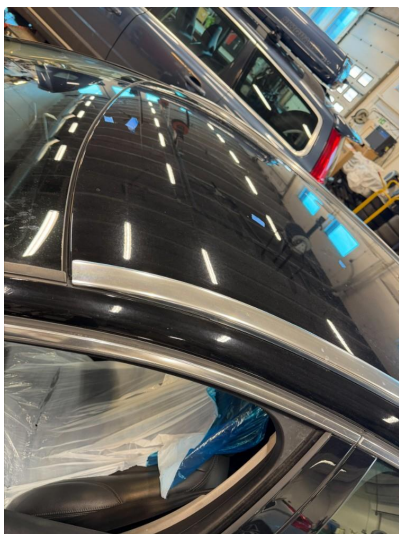
1.4 Steinsprang på tak
