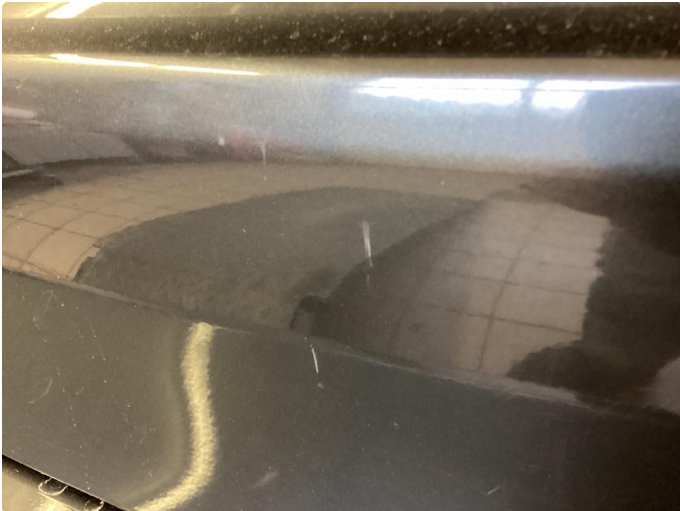
1.1 Bulk med lakkskade
