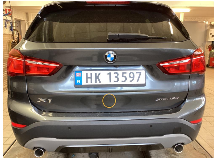
1.1 Bulk med lakkskade
