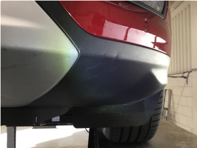
1.2 Liten klemskade i vart plast nedkant fanger foran v.side. Normal bruksslitasje.
