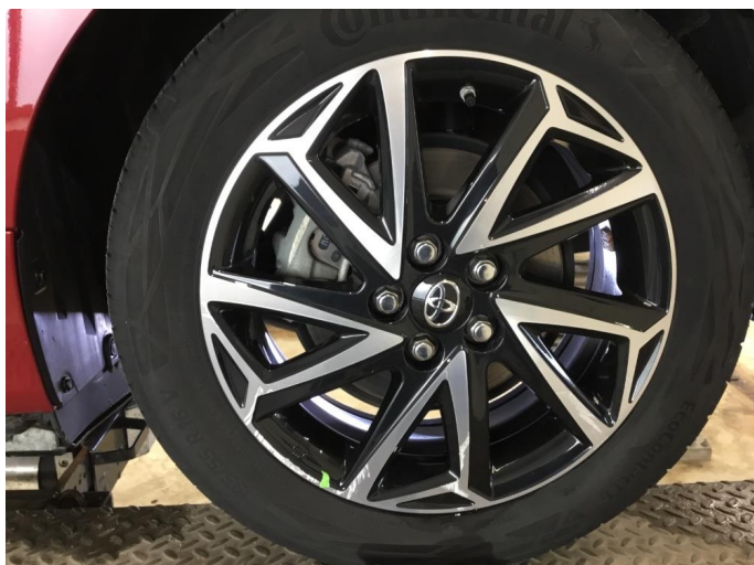
1.1 Noe skrapeskader sommerfelg venstre bak. Bruksslitasje.
