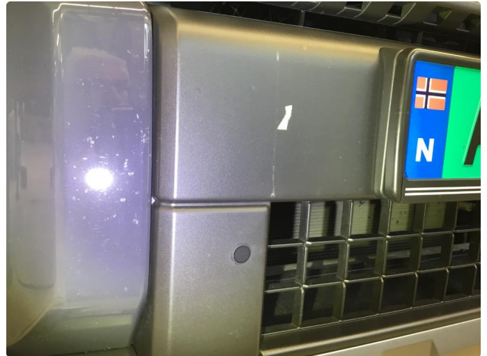
1.1 Lite merke i støtfanger foran. Bruksslitasje.
