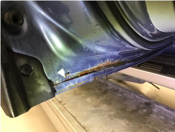
1.2 Rust i fals bunn på v.bakdør.
