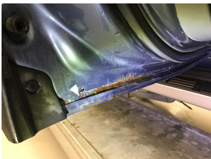
1.3 Rust i fals bunn på v.bakdør.
