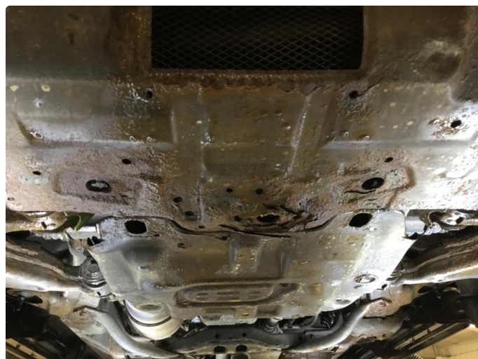
1.2 Rust i beskyttelsesplate under motor, og beskyttelsesplate under tank.
