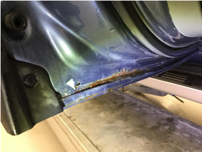
1.2 Rust i fals bunn på v.bakdør.
