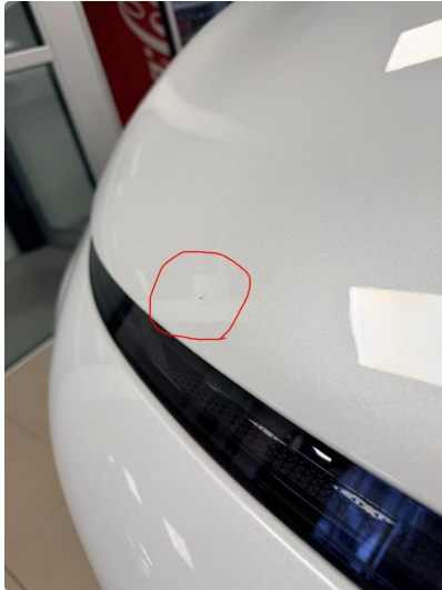
1.1 Hakk/Steinsprut i panser.
