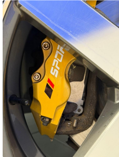
2.1 Bremsen har gull farget deksel på bremse kalipere Løsnet på Høyre foran.
