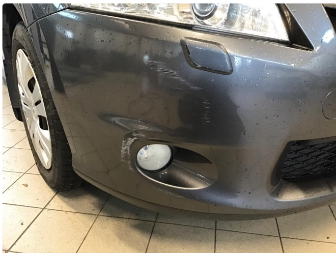
1.3 Ripe(r) ned til grunning
