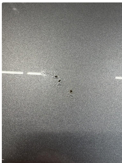
1.2 Steinsprut med rust
