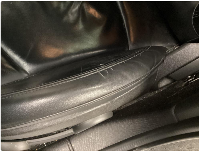
9.2 Skade på setepute/slitt
