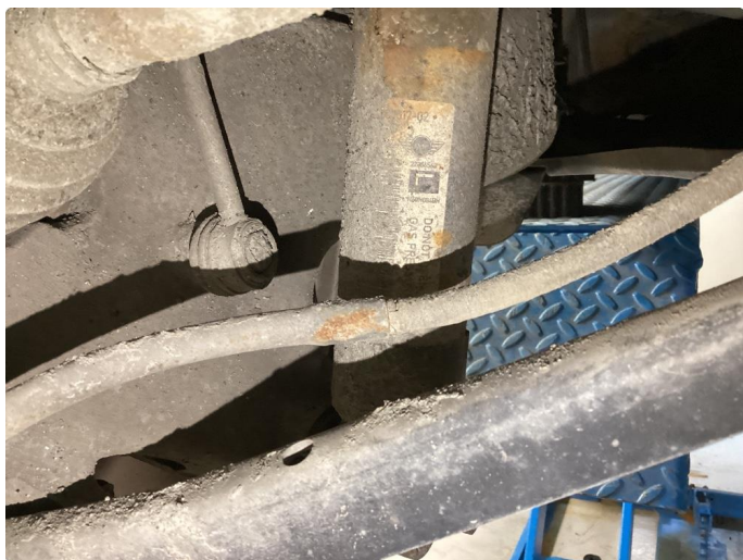
7.1 Defekt strømppe bremsewire bak, begge sider
