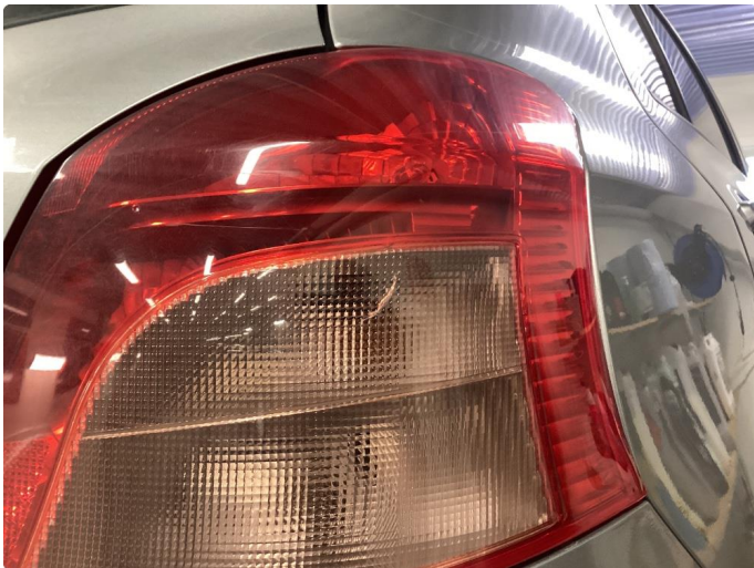
2.1 Defekt / sprukket glass, høyre baklykt.
