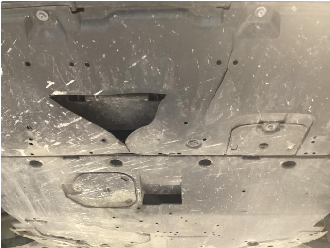
1.2 Beskyttelsesplate under motor skadet/mangler. Sprukket.
