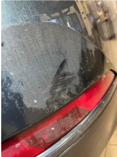
1.1 Ripe(r) ned til grunning
