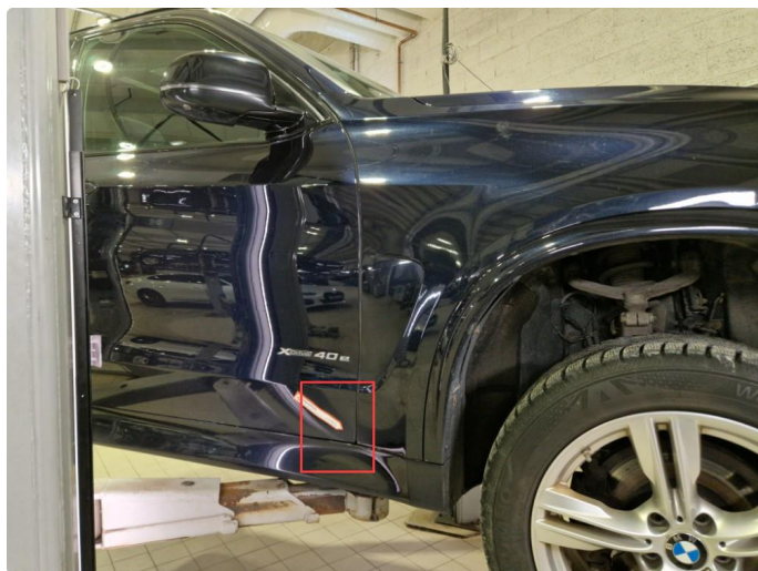
2.4 Rust nedre fremre del hframdør.
