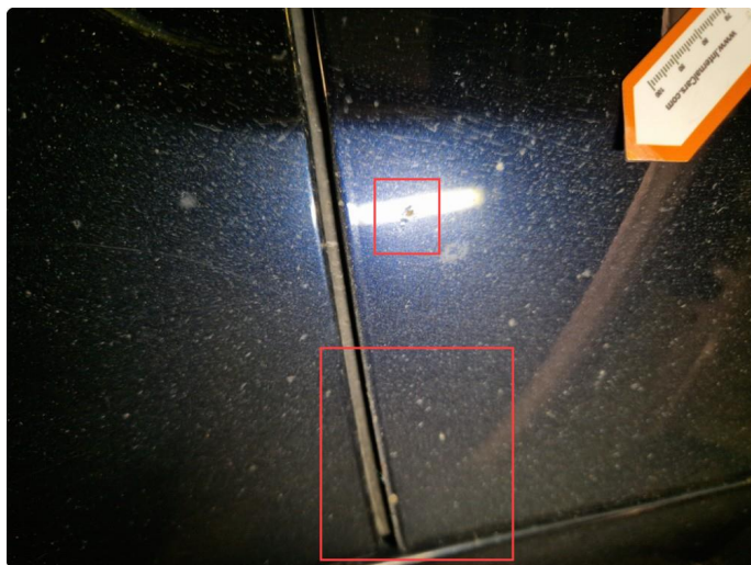
2.3 Flere rustbobler nedre fremre og bakre del v-framdør.
