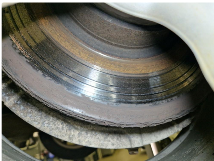
5.2 Rust / slitte bremseskiver fram + noe pulsering. Bremseskiver målt til 5mm.
