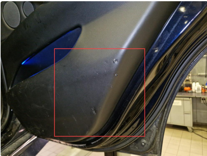
7.1 Noe merker i dørtrekk, høyre bakdør.
