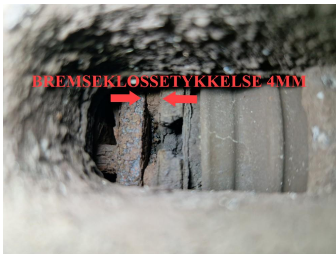
5.1 Slitte bremseskiver bak, målt til 4mm. Bremseskiver OK.
