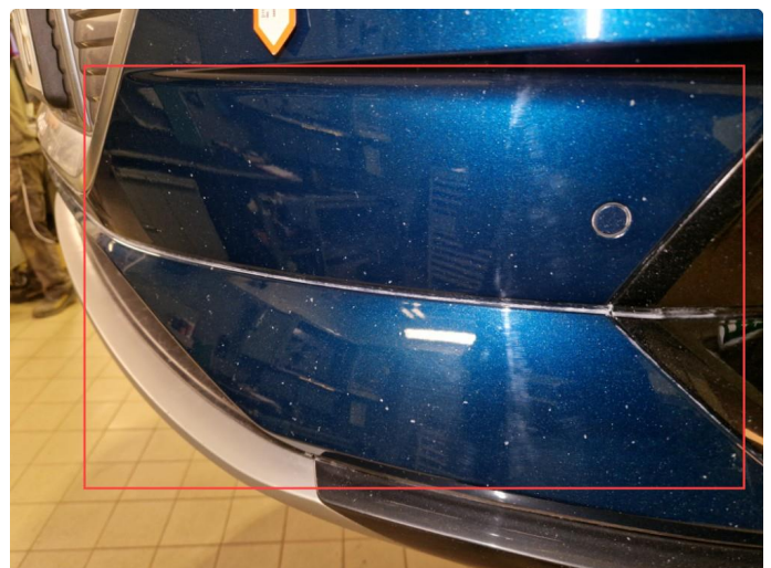
1.3 En del steinsprut.
