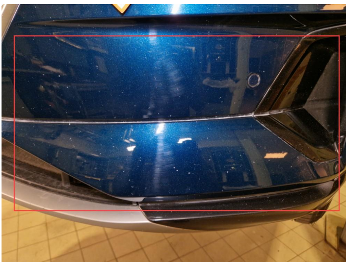
1.3 En del steinsprut.
