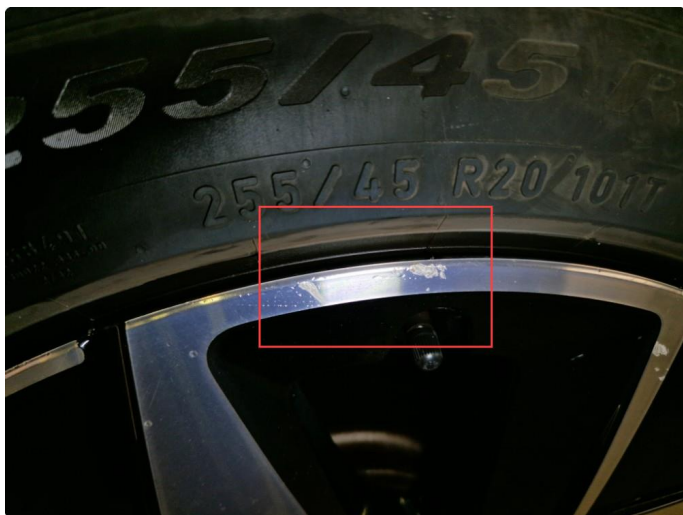
1.3 Noe sår / bruksmerker sommerfelg høyre fram . Normal bruksslitasje.
