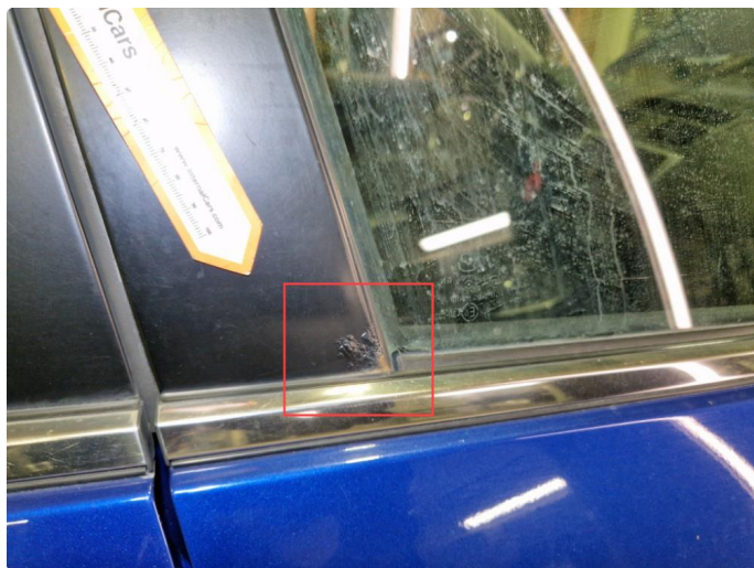
1.3 Rust/korrosjon. Rust / korrosjon pyntedeksel h+v framdør.
