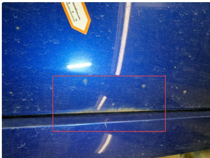
1.4 Rust / bruksmerker alle dører.
