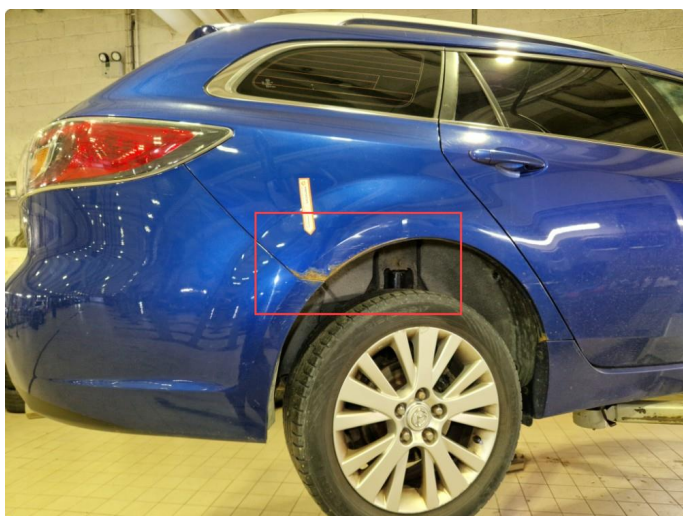
1.5 Rust / lakkskader alle skjermer.
