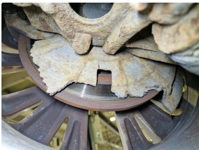
4.1 Rust / slitasje bremseskiver fram og bak.
