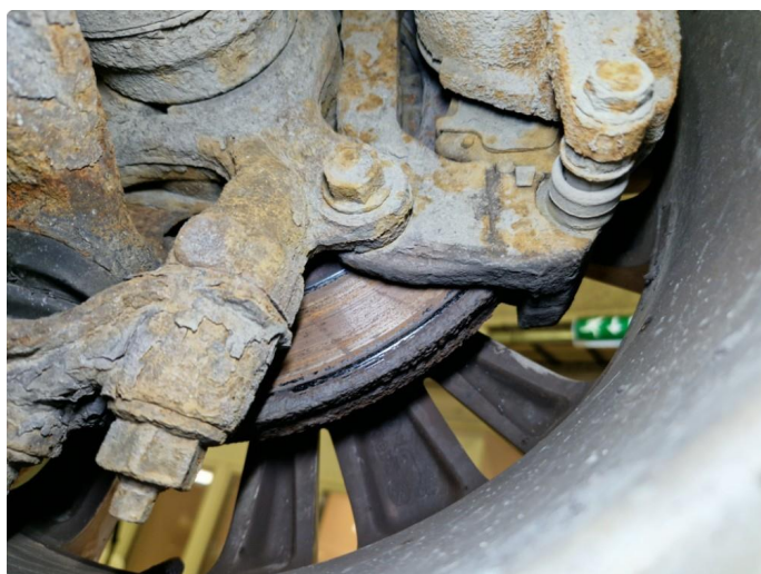
4.1 Rust / slitasje bremseskiver fram og bak.
