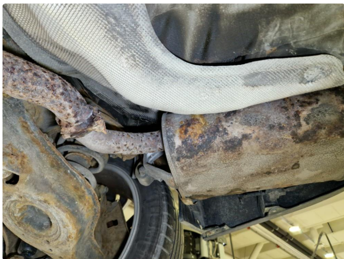
3.2 Rust eksosanlegg, spesielt i skjøter.
