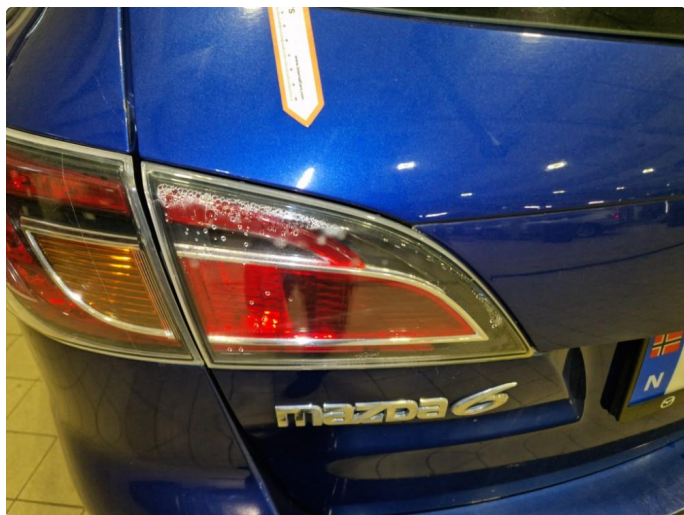
2.1 Fukt indre baklykt h+v side.
