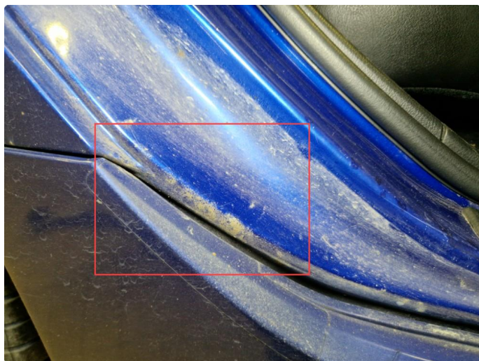
1.5 Rust / lakkskader alle skjerner.
