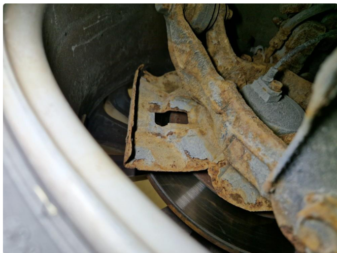
4.2 Rust / skadet bremseskjold h+v side bak.
