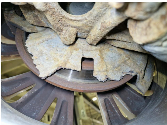
4.2 Rust / skadet bremseskjold h+v side bak.
