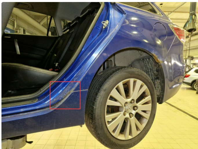
1.5 Rust / lakkskader alle skjermer.
