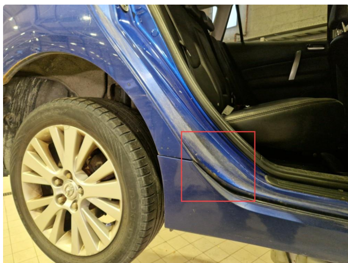
1.5 Rust / lakkskader alle skjerner.
