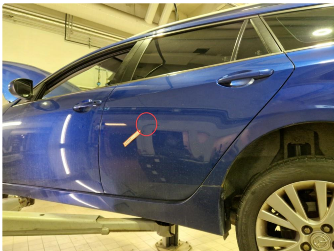
1.4 Rust / bruksmerker alle dører.
