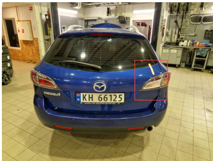
2.1 Fukt indre baklykt h+v side.
