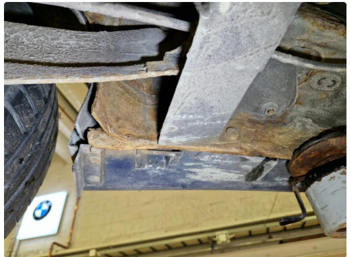
1.2 Rust underside bil, for / bakstillingsdeler, traverser og ved kanal h+v side
