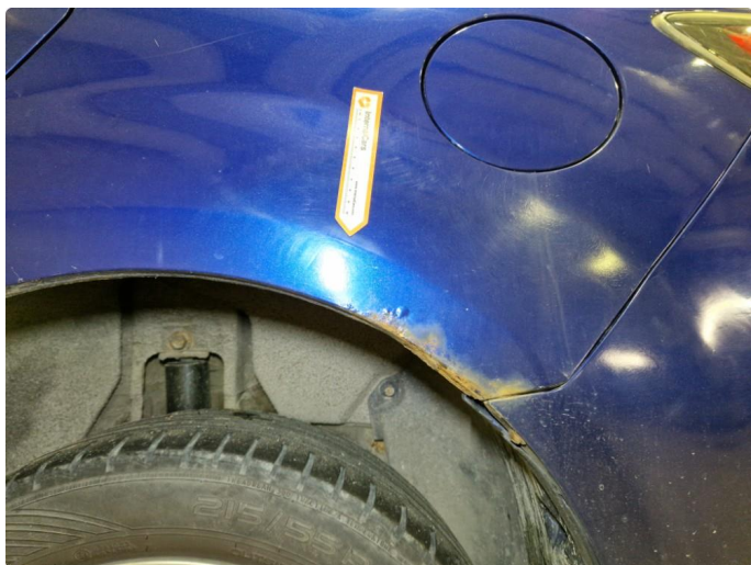
1.5 Rust / lakkskader alle skjerner.
