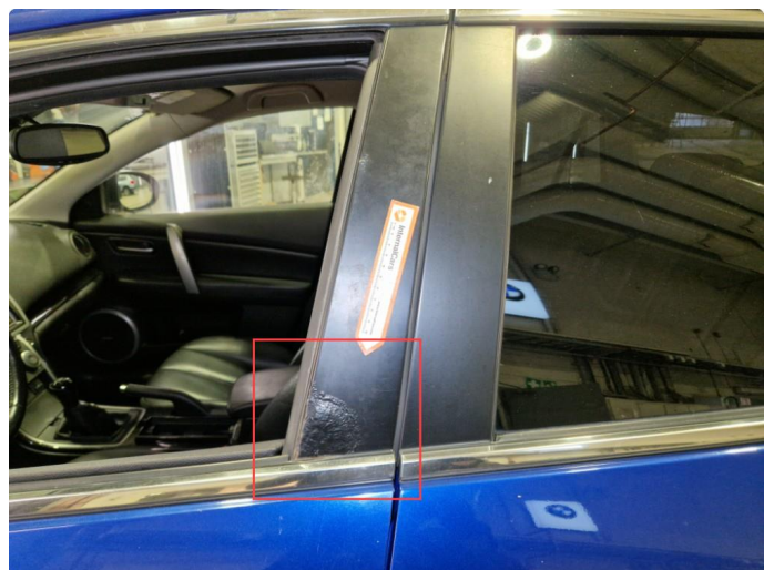
1.3 Rust/korrosjon. Rust / korrosjon pyntedeksel h+v framdør.
