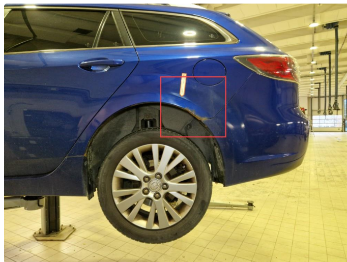
1.5 Rust / lakkskader alle skjermer.
