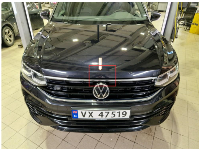
1.1 Noen steinsprut fremre del panser.
