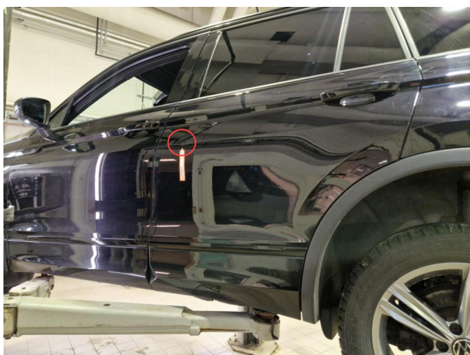
1.2 Stk liten p-bulk v-bakdør + 1 stk liten rustboble ( Normal bruksslitasje )
