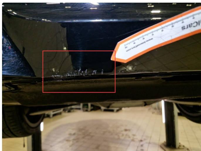
1.3 Noe bruksmerker nedre del diffusor bakfanger ( Normal bruksslitasje )
