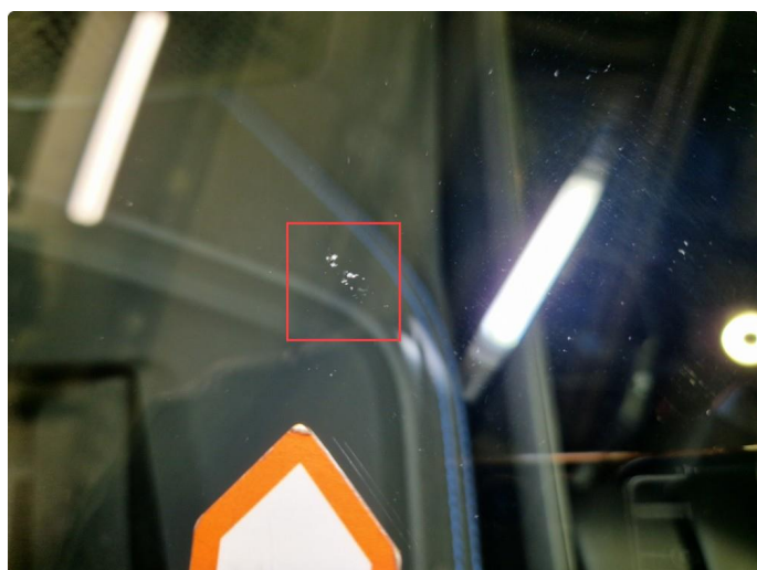
1.4 2 Stk små steinsprut frontrute, for små til og repareres pr. nå. ( Normal bruksslitasje )
