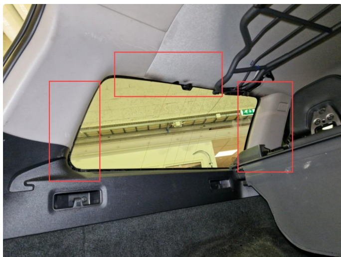
3.1 Flekker / merker på flere paneler / stoffbekledning h+v side bagasjerom + bakluke.
