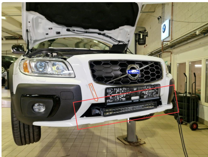
1.7 Nedre midtre grill fjernet pga montering av ekstralys
