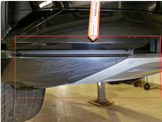
1.1 Lakkskade nedre del h-side
