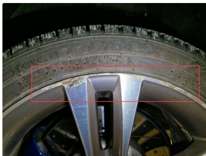
1.5 Korrosjon vinterfelg v-fram og v-bak.
