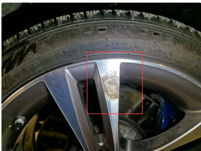
1.5 Korrosjon vinterfelg v-ram og v-bak.
