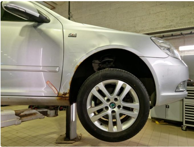
2.9 Rust fremre del kanal h+v side.
