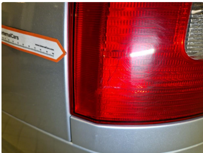
3.1 Sprekkdannelser baklykt h+v side.
