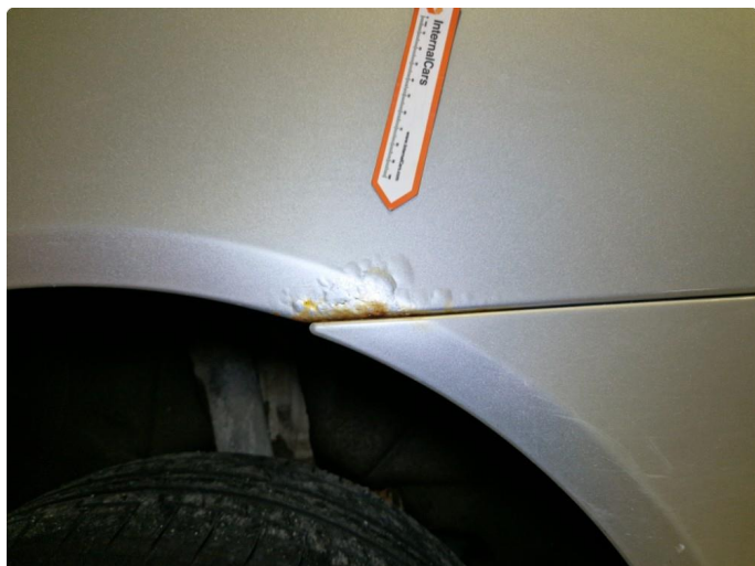
2.3 Rust / skader alle skjærmer.
