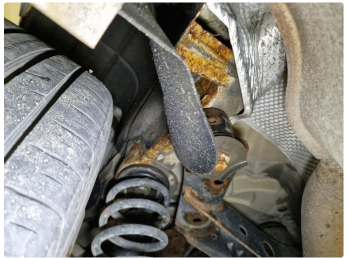
2.1 Noe rust underside bil ved bakstilling.
