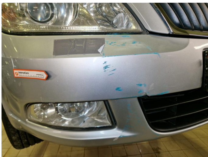
2.6 Skader / bruksmerker frontfanger.
