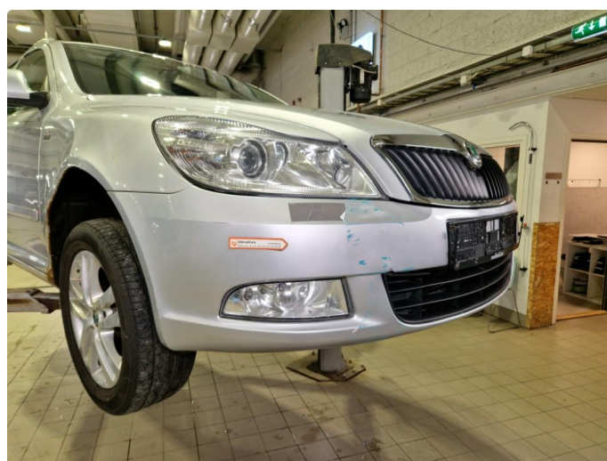
2.6 Skader / bruksmerker frontfanger.
