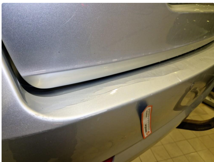
2.7 Skader / bruksmerker bakfanger.
