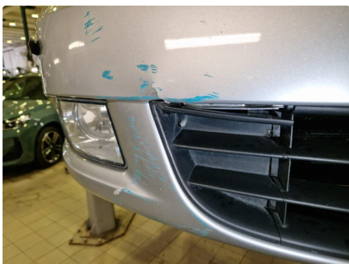
2.6 Skader / bruksmerker frontfanger.
