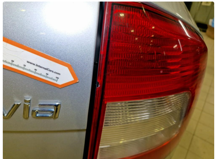
3.1 Sprekkdannelser baklykt h+v side.
