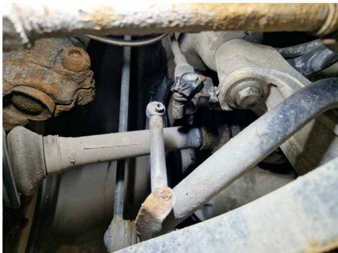
1.1 Skadet stagg til nivåsensor v-fram.
