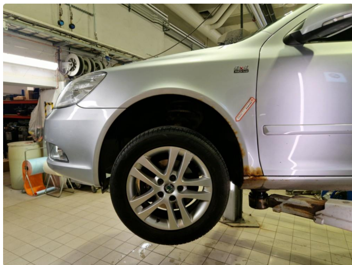
2.3 Rust / skader alle skjærmer.
