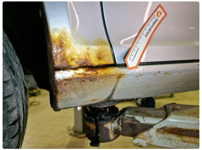
2.9 Rust fremre del kanal h+v side.
