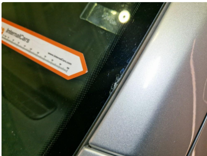
2.8 Steinsprut / skade v-side frontrute.
