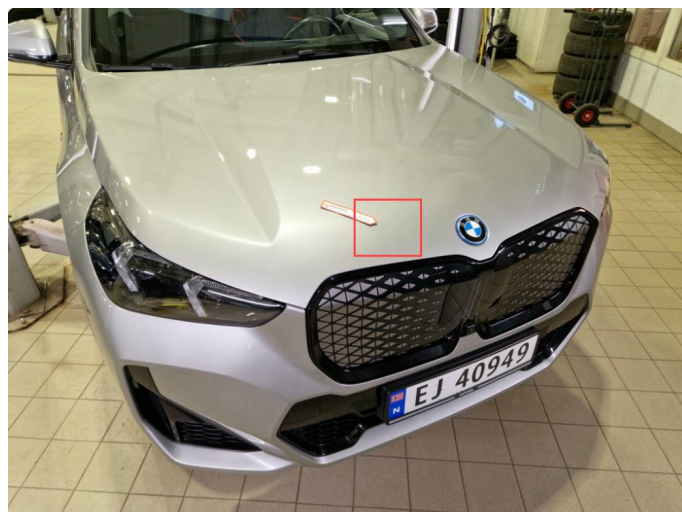
1.1 1 Stk steinsprut med lakksår og liten fordypning panser, normal bruksslitasje.
