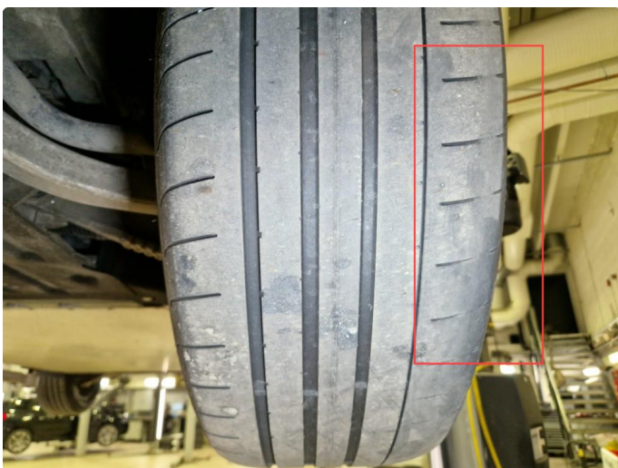
1.3 Sommerdekk skjevslitasje + slitt.
