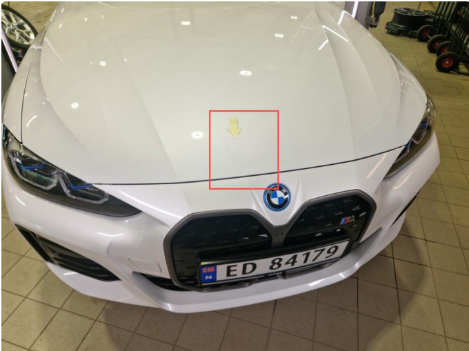
1.1 Noen steinsprut fremre del panser ( Normal bruksslitasje)
