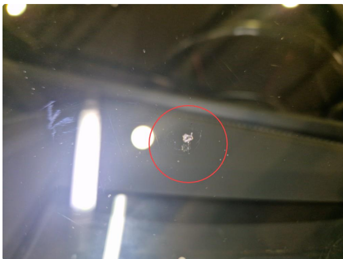
1.5 Steinsprut frontrute , er reparert tidligere.
